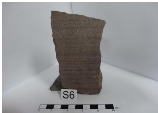
รูปที่ 2.14 หินทรายหมวดหินน้ำพอง หมายเลข S6 หินทรายสีม่วงอมน้ำตาลแสดง lamination ของ mud (สีน้ำตาลเข้ม) ลักษณะคล้ายกับหินตัวอย่าง S5 แต่มีเม็ดตะกอนใหญ่กว่า และเนื้อไม่แน่นมาก มีตัวเชื่อมประสานเป็นออกไซด์ของเหล็ก
