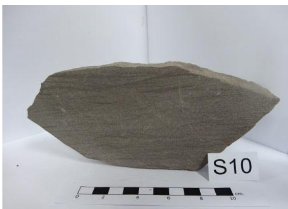
รูปที่ 2.20 หินทรายหมวดหินโคกกรวด หมายเลข S10 ซึ่งหินโผล่อยู่บริเวณทางน้ำล้น (spillway) เขื่อนน้ำพุง อ.ภูพาน จ.สกลนคร เป็นหินทรายเนื้อละเอียดสีน้ำตาลอ่อนอมแดง แสดง lamination และ cross-lamination ชัดเจน ซึ่งเป็นตะกอนที่ขนาดละเอียดกว่า (บริเวณสีเข้ม)
