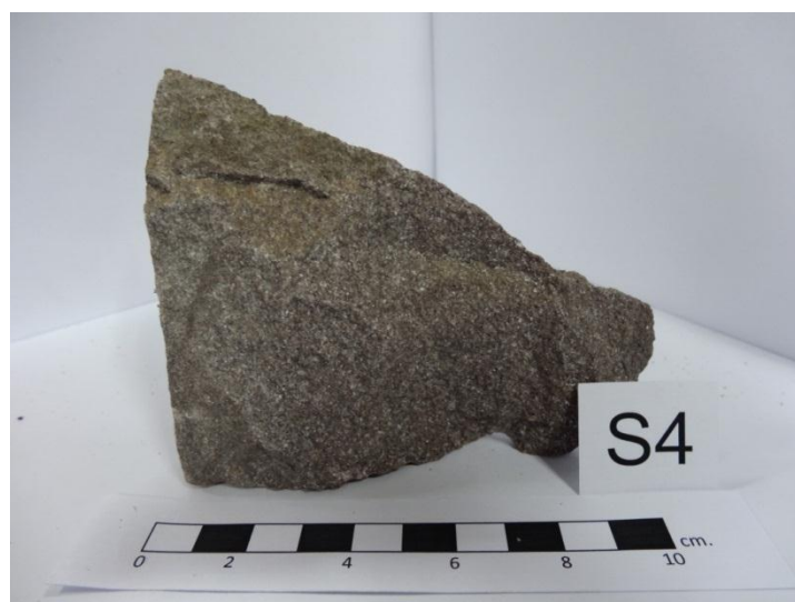
รูปที่ 3.8 ตัวอย่างหินทรายหมวดหินภูกระดิ่ง หมายเลข S4 วัดชัยภูมิพิทักษ์ ถนนทางหลวงหมายเลข 2159 (อ.เมือง-อ.หนองบัวแดง) จังหวัดชัยภูมิ หินทรายสีม่วงน้ำตาล การัดขนาดตะกอนปานกลางถึงดี ตะกอนรูปร่างค่อนข้างกลม ประกอบด้วยแร่ควอตซ์เป็นหลัก พบแร่เฟลด์สปาร์บ้าง
