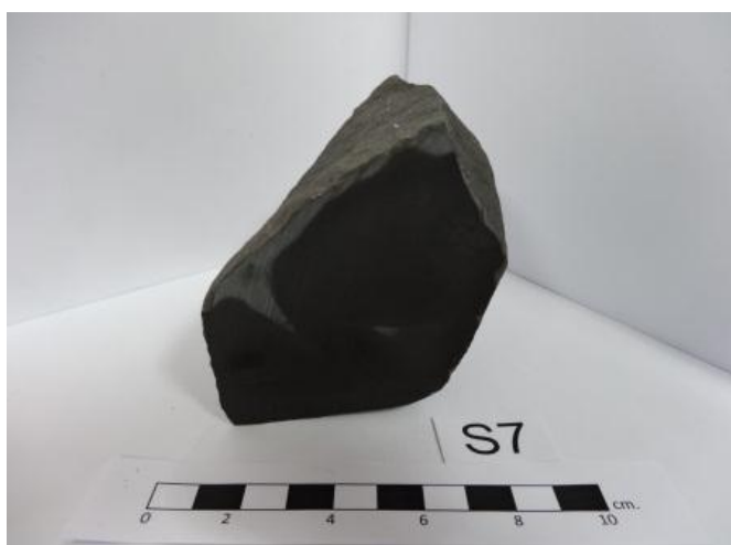
รูปที่ 3.2 ตัวอย่างหินทรายหมวดหินห้วยหินลาด บ.ศิลา ต.ศิลา อ.หล่มเก่า จ.เพชรบูรณ์ หินโคลนสีเทาเข้มอมเขียว เนื้อแน่น ประกอบด้วยเม็ดแร่ควอตซ์และแร่ดินเป็นส่วนใหญ่
